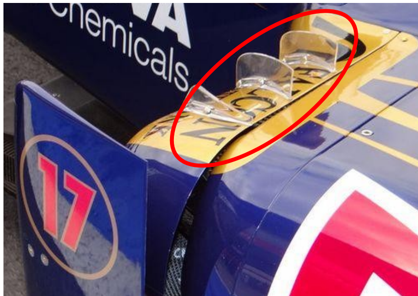
Imatge 22: generadors de vòrtex marcats en vermell.
