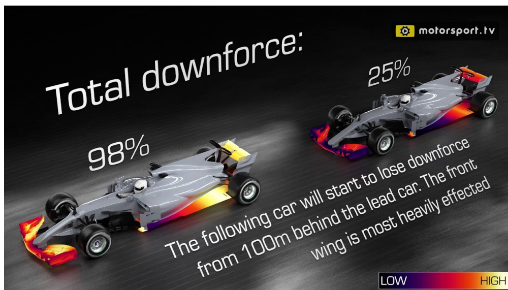
Imatge 11: il·lustració que mostra el downforce total a un cotxe en aire net i aire brut (anterior a 2022). Imatge extreta de: https://lat.motorsport.com .
