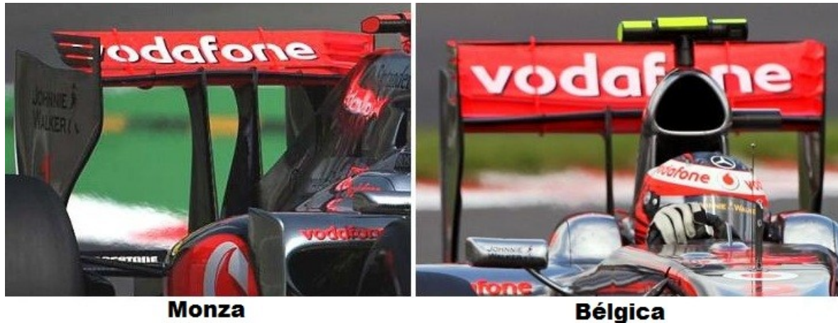
Imatge 3: aleró posterior amb diferents configuracions. Imatge extreta de: https://secretosf1.wordpress.com .
