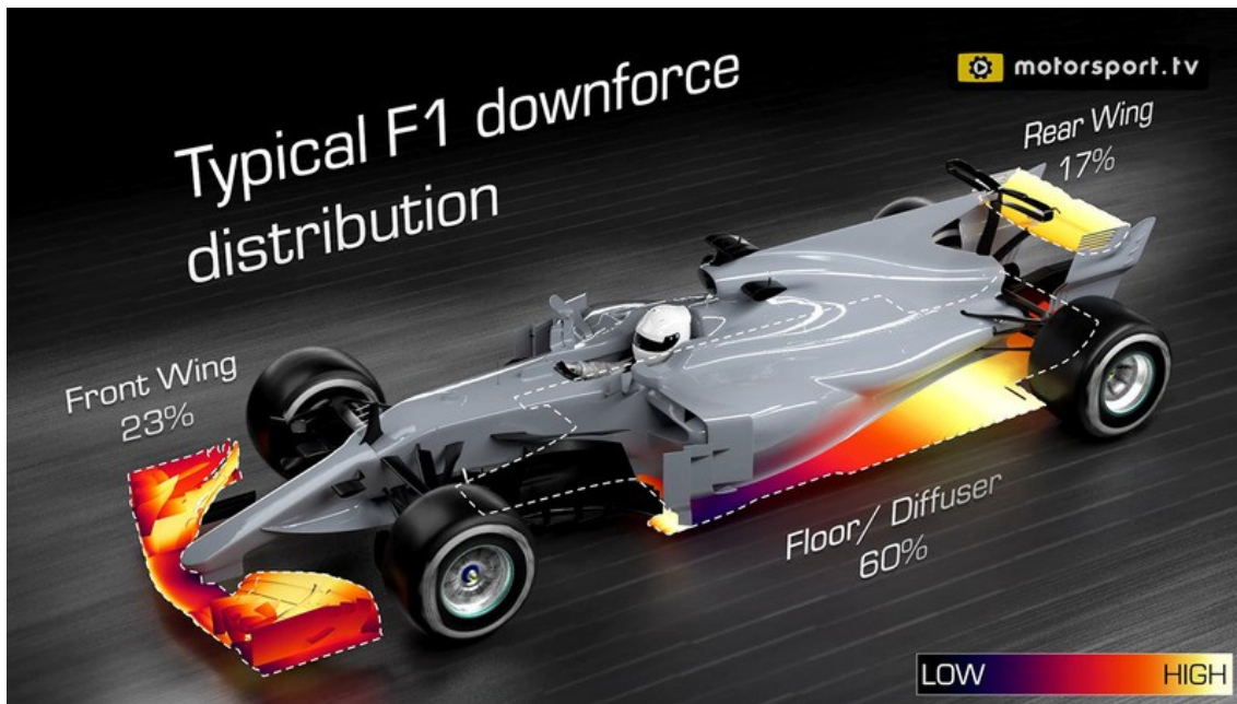
Imatge 34: distribució de downforce a un F1 del 2017. Imatge extreta de: https://lat.motorsport.com/f1/photos .
